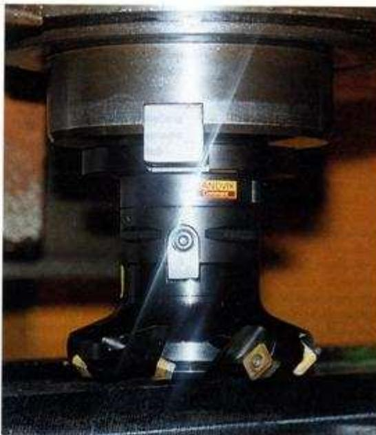
La nuova fresa CoroMill 245 per splanatura di Sandvik Coromant.
